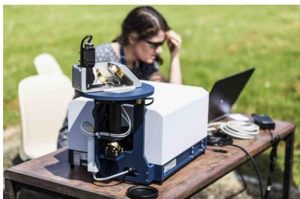
L'EM27 est un spectromètre à transformée de Fourier portable. Il est équipé d'un héliostat piloté par une caméra qui renvoie le rayonnement solaire dans le spectromètre avec une direction constante. La haute résolution (de 0,5 cm<sup>-1</sup>) permet de résoudre les raies des composés minoritaires de l'atmosphère. Le spectromètre enregistre des spectres dans l'infrarouge entre 2,5 et 0,8 micromètre avec deux détecteurs. Un logiciel de transfert radiatif
