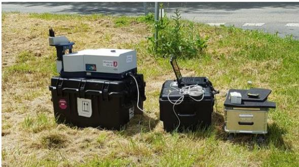
Le spectromètre infrarouge CHRIS est un prototype instrumental développé pour le Laboratoire d'optique atmosphérique (LOA, CNRS/Université de Lille) par la société Bruker. Ses caractéristiques générales (masse, volume) ainsi que son fonctionnement sur batterie, lui permettent d'effectuer des mesures de terrain avec une autonomie d'une douzaine d'heures. Ses caractéristiques optiques
