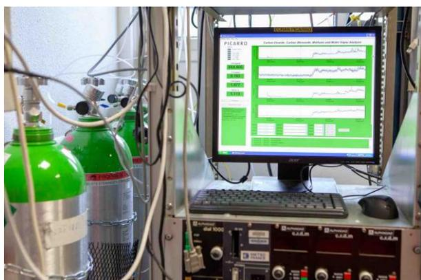
Analyseur d'air atmosphérique Picarro pour la mesure de concentration de  $\text{CO}_2$ ,  $\text{CH}_4$  et  $\text{CO}$ , volant à bord du Falcon 20 de Safire, ici en calibration en laboratoire © CNES/Nicolas TRONQUART, 2018
