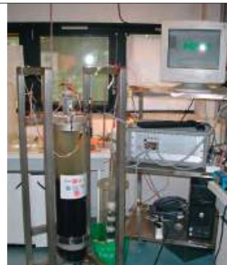
rieures à 1,23 Volts, l'électrolyse microbienne devient possible à partir de tensions aussi faibles que 0,2 Volts, ce qui représente une économie de l'ordre de 80 % de l'énergie électrique consommée. Vu les productions d'hydrogène déjà obtenues en laboratoire, la technologie semble extrêmement prometteuse. ●
