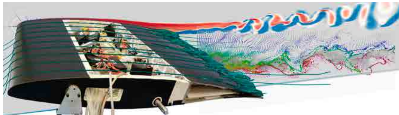
Figure 1. Mouvement de l'air autour de cette aile d'avion de type A320 illustrant la structure des turbulences et des tourbillons qui seront manipulés à l'aide du morphing. © G.Jodin, N. Simiriotes
