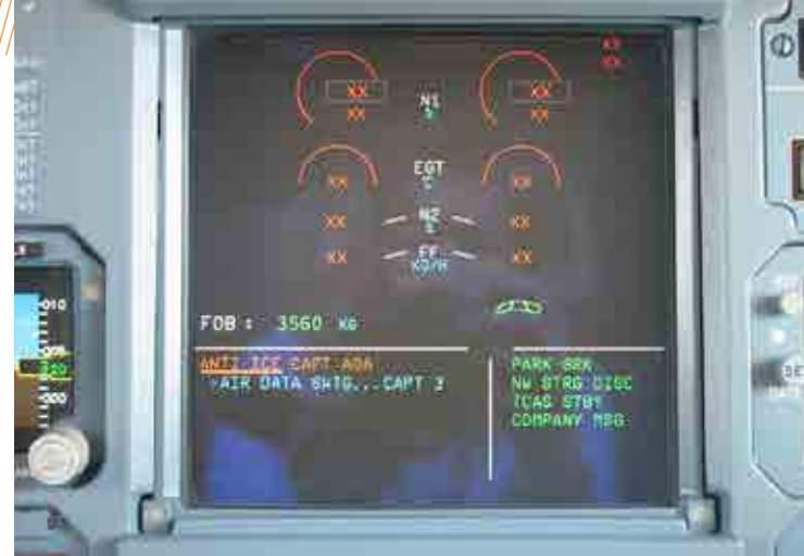
Figure 3. Partie de l'ECAM (Electronic centralised aircraft monitor) sur laquelle s'affichent les messages d'alarme dans les cockpits d'Airbus. © Agnès Voyant
