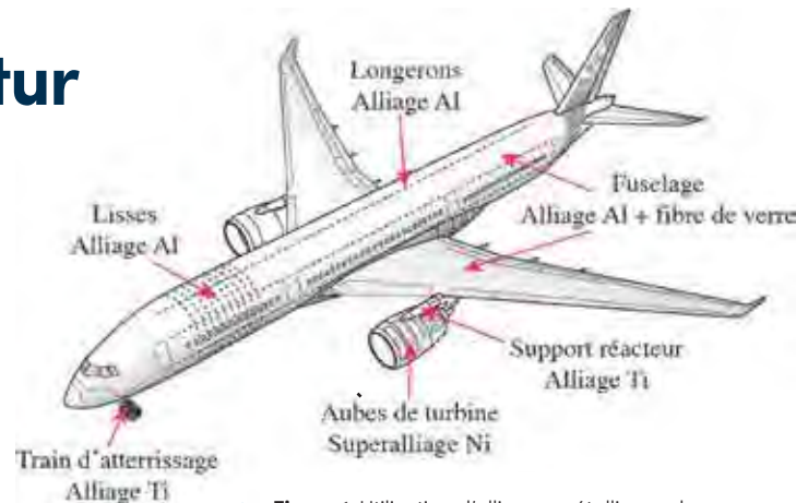
Figure 1. Utilisation d'alliages métalliques dans des zones très sollicitées de l'avion © J. Douin (CEMES)
