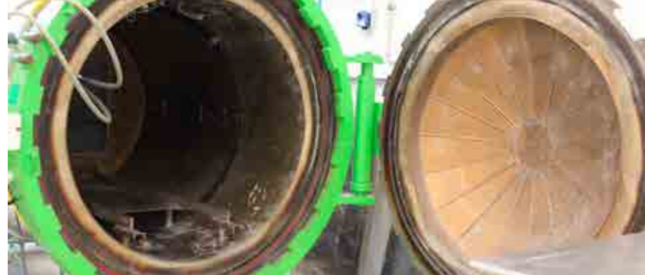
Figure 2. Autoclave de polymérisation de l'ICA. Un des outils de production des pièces stratifiées composites hautes performances. © CNRS
