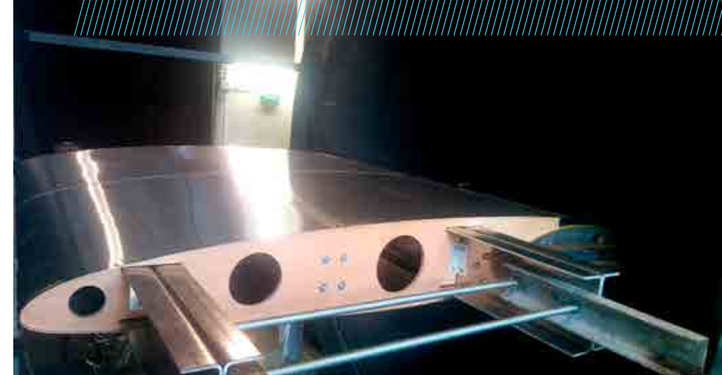
Figure 2. Prototype d'aile d'avion de type A320 avec volet hypersustentateur de corde de 1m dans la soufflerie S1. Mesures pour la phase de décollage. © J.F. Rouchon / M. Braza.
