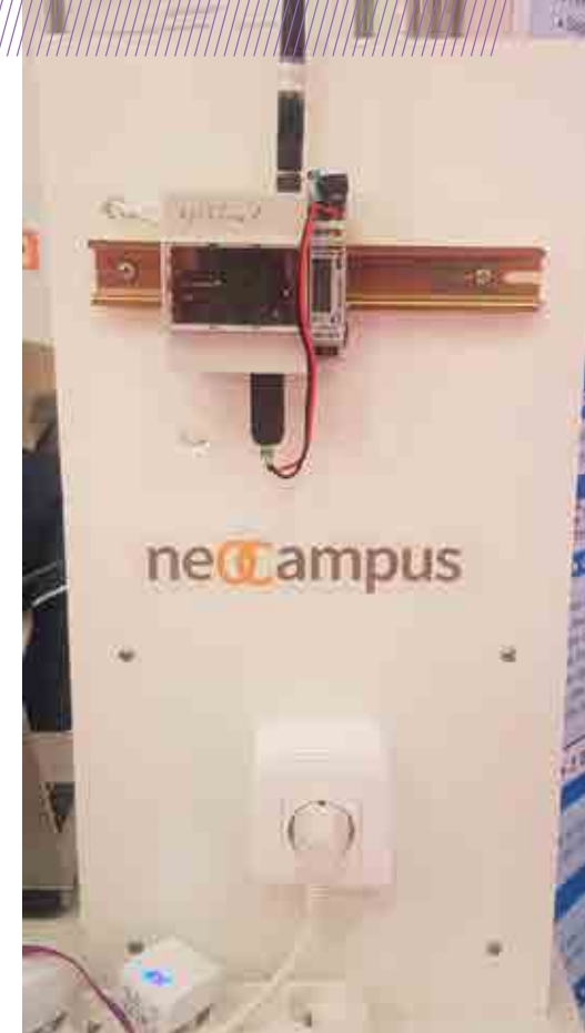
Figure 2. « Prototype d'un compteur électrique communicant longue distance (Technologie LoRa) ». © C. Turpin/LAPLACE
