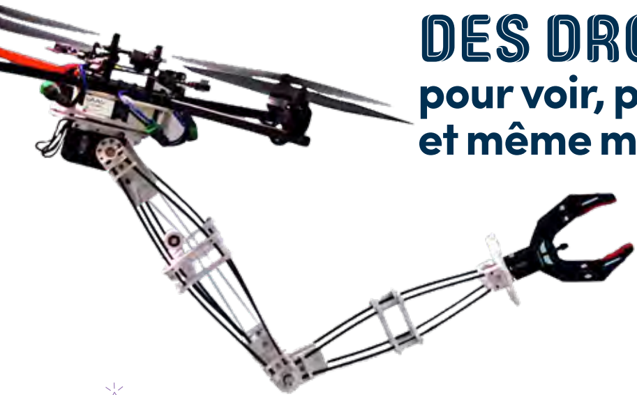
Figure 1. LAAS-Aerial-Manipulator. Muni d'un bras et d'algorithmes qui contrôlent à la fois le vol et le bras, un drone se transforme en robot aérien. © LAAS-CNRS
