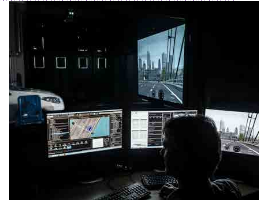
Figure 2. Banc de contrôle permettant de superviser la conduite d'une voiture autonome* sur banc VILAD (« Vehicle in the Loop for Autonomous Driving »). ©J.-C. Moschetti/HEUDIASYC/ CNRS Photothèque
