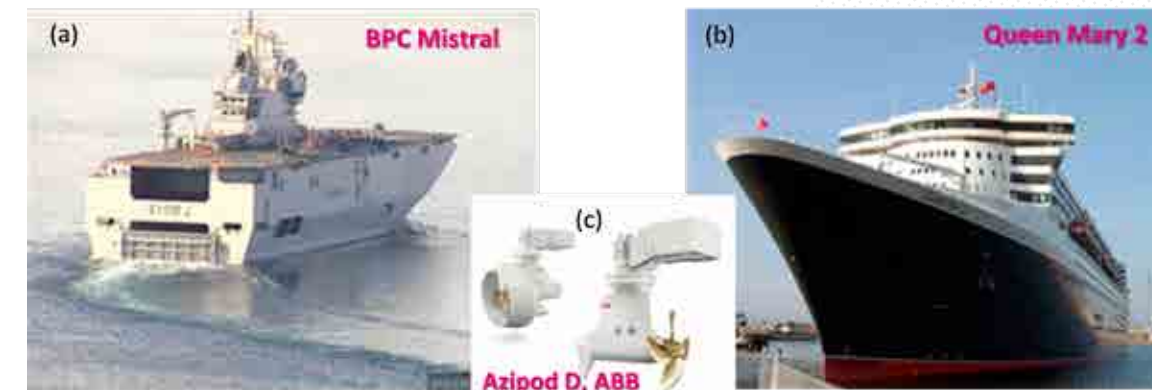
Figure 2. Navires à propulsion électrique. Le bâtiment de projection et de commandement (BPC) Mistral (a) et le paquebot Queen Mary 2 (b), propulsion électrique Azipod D, ABB, version ouverte et sa version canalisée (c) qui a permis d'augmenter de 45% l'efficacité énergétique des moteurs. © DR
