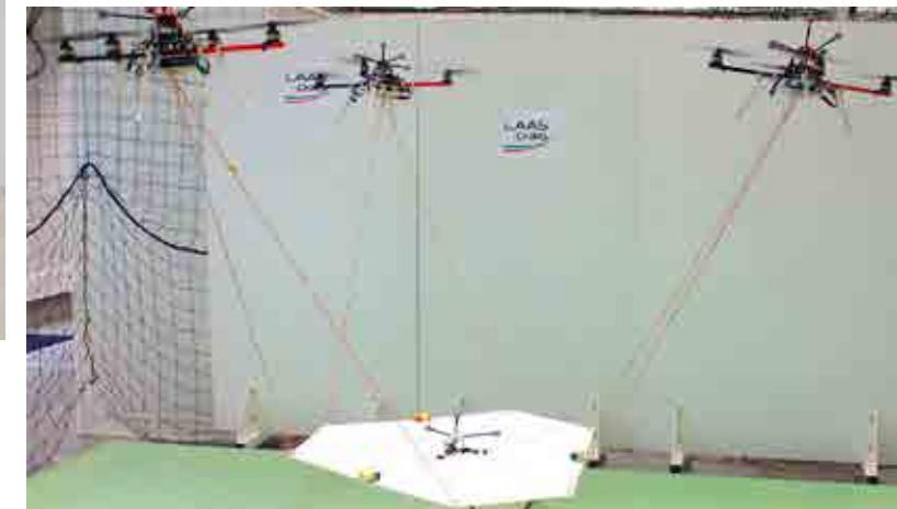
Figure 3. LAAS-FlyCrane : En coopérant étroitement entre eux, trois drones peuvent transporter et orienter précisément une pièce dans les trois dimensions. © LAAS-CNRS
