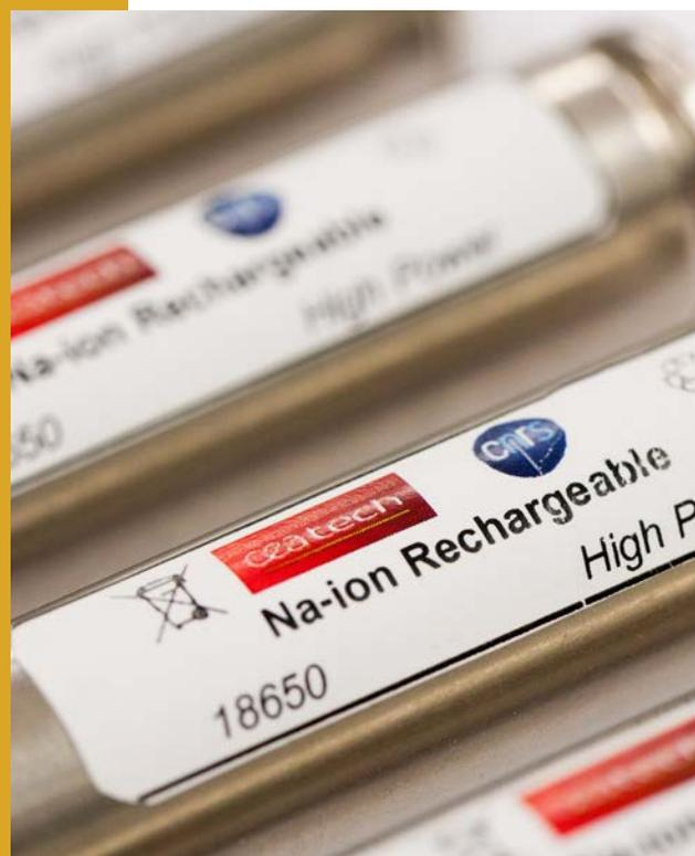
↑ Batteries sodium-ion au format industriel standard « 18650 ». Il s'agit des premières batteries au sodium mises au point dans ce format.
