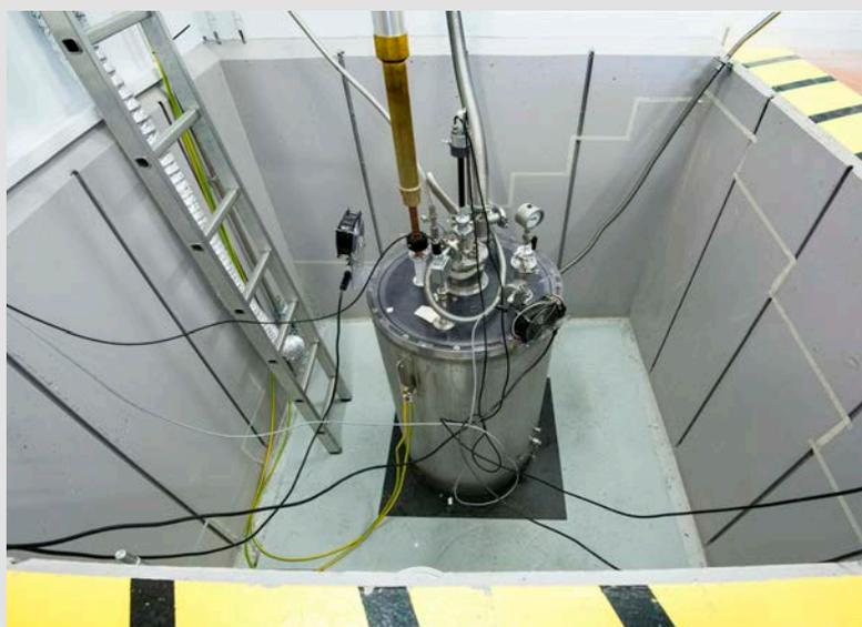
↑ Cryostat contenant un aimant pulsé dans son puits de tir au LNCMI. L'aimant est immergé dans l'azote liquide (température -196 °C) pour baisser sa résistance électrique et augmenter sa résistance mécanique.
