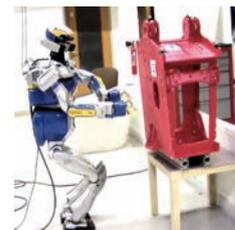
▲ Le robot humanoïde HRP-2 exécutant une tâche de vissage sur une maquette de mât d'Airbus A350
