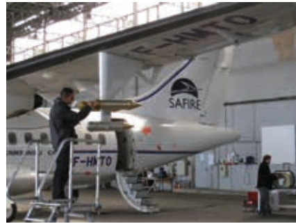
Installation d'instruments scientifiques sur l'ATR © Caroline Lamorthe/SAFIRE
