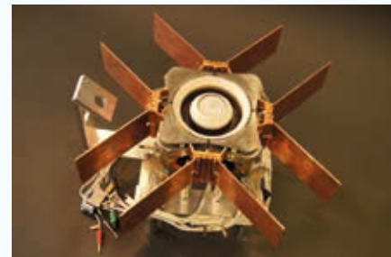
Le PPS-Flex équipé de ses ailettes de refroidissement © Dominique Harribey, Laplace (CNRS, UT3, INPT)
