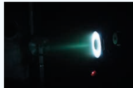
Le PPS-Flex allumé dans un caisson sous vide où sont recréées des conditions spatiales © Dominique Harribey, Laplace (CNRS, UT3, INPT)
