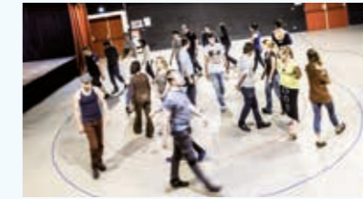
Dispositif expérimental utilisé pour analyser les déplacements et les interactions entre piétons. Cette technique développée par le LAAS-Toulouse permet de suivre les déplacements de chaque individu dans le groupe et de leur délivrer en temps réel une information qui va dépendre de l'état de leurs plus proches voisins. Ces expériences permettent de déterminer quelle combinaison d'informations publique et privée permet d'optimiser la capacité d'un groupe à se ségréger et promouvoir ainsi la coopération entre individus. © D. Villa, Sciencemage, CBI/CNRS, Toulouse.
