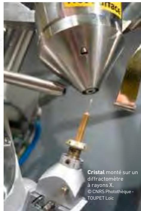
Cristal monté sur un diffractomètre à rayons X.
