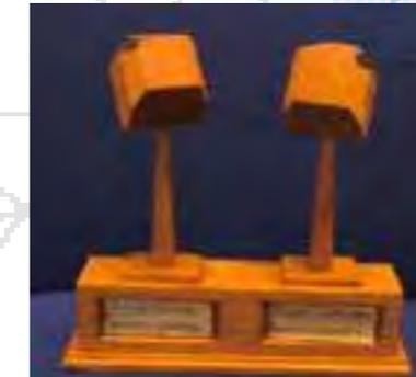
▲ Modèle des deux cristaux de tartrates, tels que ceux séparés par Pasteur. © Société des amis de Pasteur
