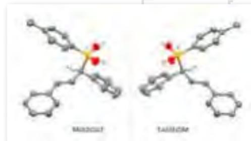
▲ **Structures cristallines** de deux énantiomères d'un composé sulfone déterminées par diffraction des rayons X.
