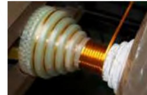
Fabrication d'une bobine de champs magnétiques pulsés 40 Tesla à grandes ouvertures angulaires pour la diffraction des neutrons. © Julien Billete, LNCMI-T
