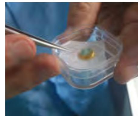
**Photographie de la pastille d'or** d'un diamètre de 8 mm où se déroulera la course de molécule-voitures. Cette pastille est présentée ici en son habillage de protection avant montage sur son support et introduction dans le microscope.
