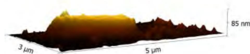
Figure 2 : image AFM d'un assemblage molécules/nanoparticules. On observe la morphologie globale de l'objet, sur lequel on pourra venir positionner la pointe avec précision. ©Marine Tassé - LCC
