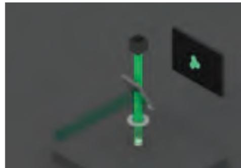
**Figure 2 :** Schéma de la microscopie optique de fluorescence. Un objet est éclairé par une lumière blanche filtrée dans le bleu. Cet objet contient des marqueurs fluorescents qui répondent en émettant une lumière verte collectée par le détecteur.
