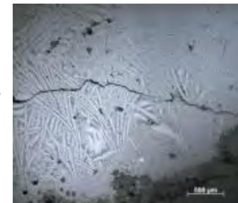
Vue microscopique de la scorie. À partir de la face inférieure (zone noire en bas à droite), on observe des cristaux sous forme de grandes lattes de silicates de fer (fayalite) dans du verre interstitiel (gris foncé). En gris clair, en bas à gauche, on retrouve les dendrites de wüstite déjà vues dans les inclusions des barres de fer. Cette structure renseigne sur les conditions de formation de ces déchets et donc du déroulement des opérations métallurgiques. © TRACES
