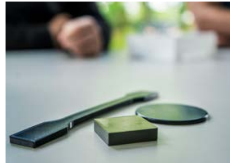
▼ Echantillons de vitrimères, résines dont le réseau interne est dynamique © Mélina Le Corre
