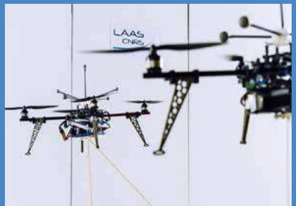
Test d'un système multi-robots aérien capable de manipuler des objets © Cyril FRESILLON / LAAS / CNRS Photothèque
