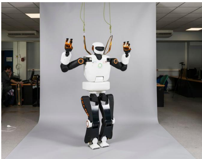
Le robot humanoïde TALOS du LAAS-CNRS, nommé Pyrène, est doté d'une structure complexe équipée de 32 moteurs électriques. Pyrène est conçu pour porter de lourdes charges, monter ou descendre des escaliers, s'adapter à des sols instables, se servir d'outils pour effectuer des actions complexes. © Cyril FRESILLON / LAAS / CNRS Photothèque
